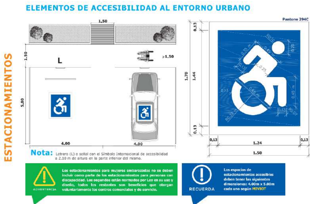
Ilustración 49: Detalle de estacionamientos. Fuente: (Manual de Acceso)
