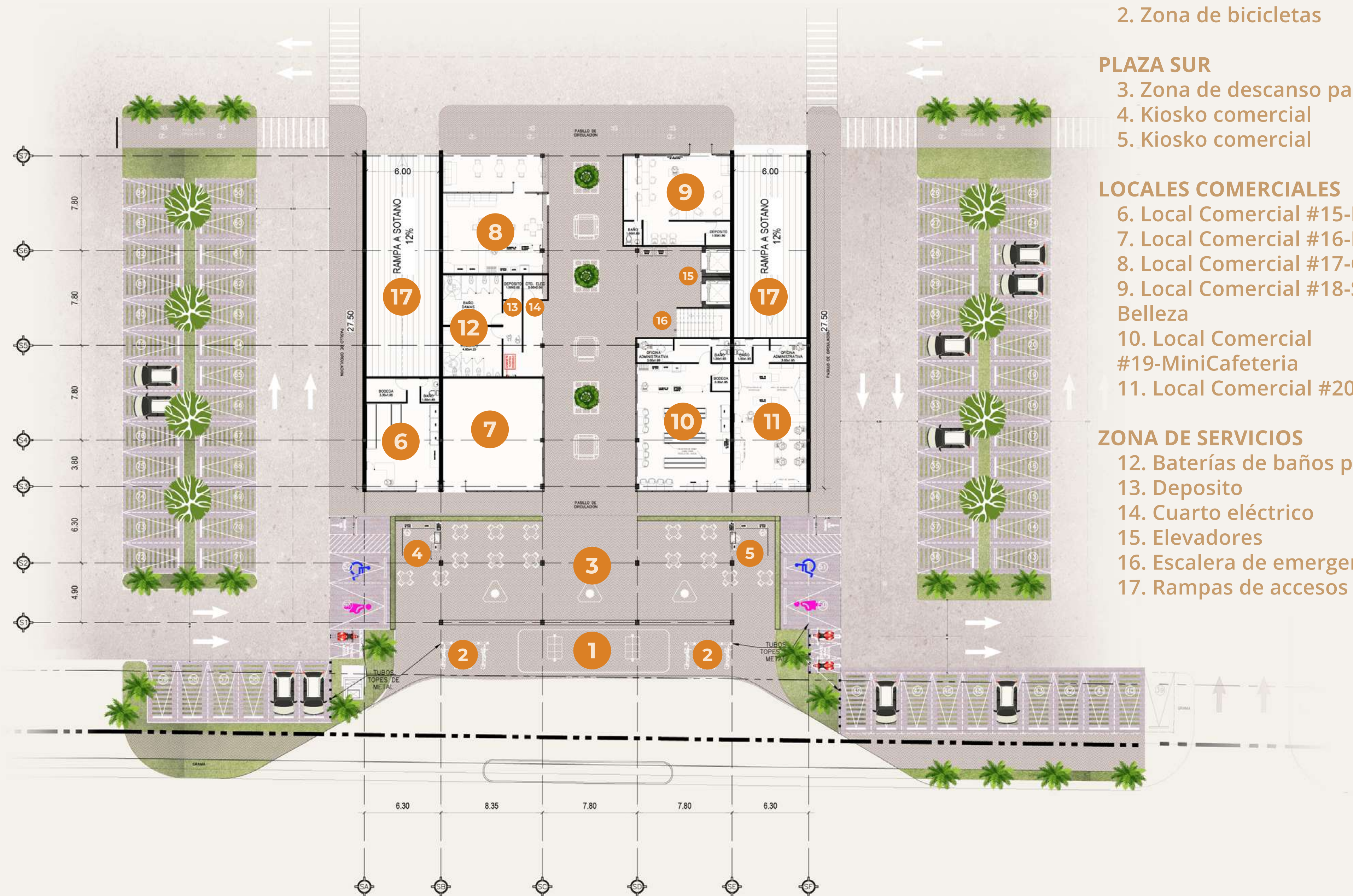
PLANTA ARQUITETÓNICA | EDIFICIO SUR | PLAZA SUR ESC 1:200
