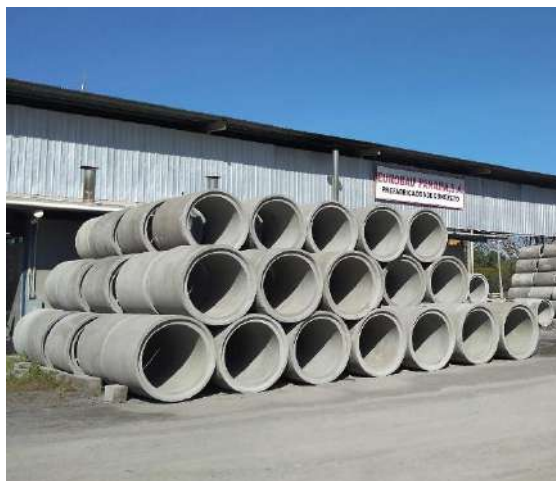
Figura 75. Alcantarillado de Concreto. Fuente: Internet
