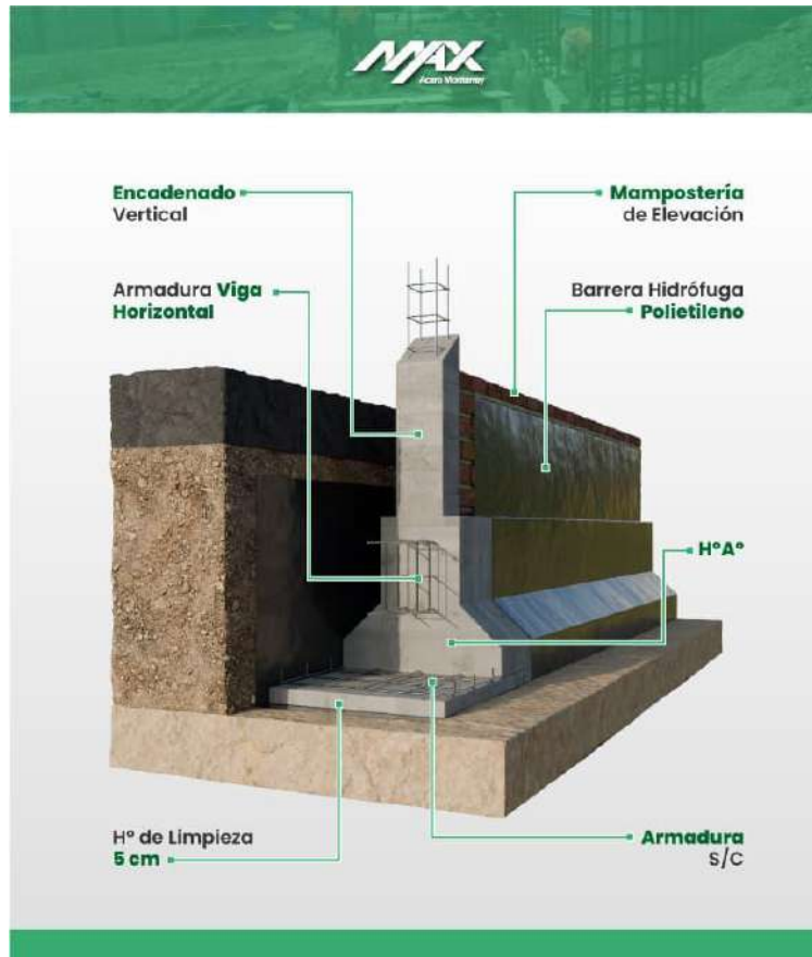
Imagen 43. Zapata corrida. Fuente: https://maxacero.com/blog/zapata-corrida-no-la-utilices-sin-saber-estas-5-cosas/
