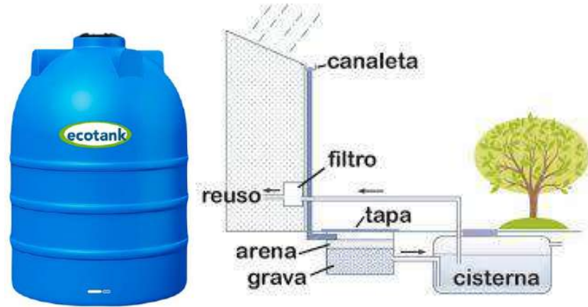
Ilustración 202: tanque de agua con capacidad de 5000 L (izq.) y esquema para el sistema para captación de agua pluvial (der.). Extraído de https://www.hopsa.com/plomeria/tanques-de-agua/tanque-reserva-de-agua-ecotank-5000-lts-azul-tricapa-34201105.html
