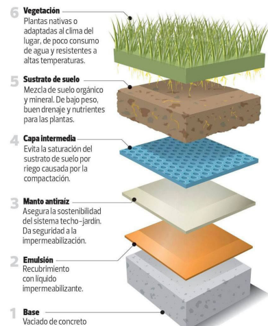
Ilustración 35: Detalle de instalación de techos verdes
