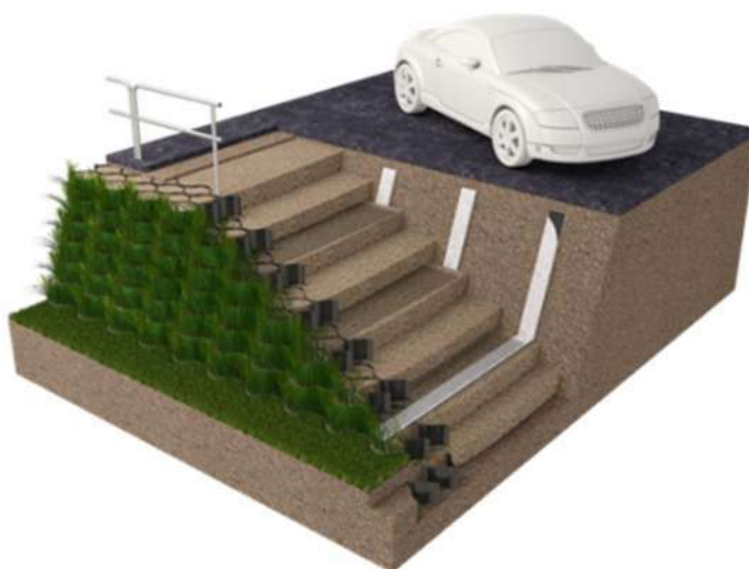
Imagen 72: Muro de geoceldas tipo web. Fuente: https://abg-geosynthetics.com/es/products/geocells/webwall-geocell/
