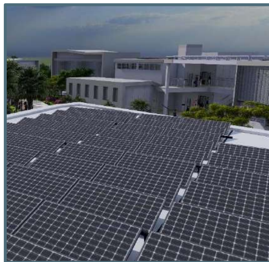
Imagen 68: Paneles solares en la cubierta del auditorio. Elaborado por el autor.
