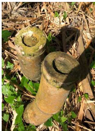
Figura 18. Corte adecuado de una vara de bambú.
