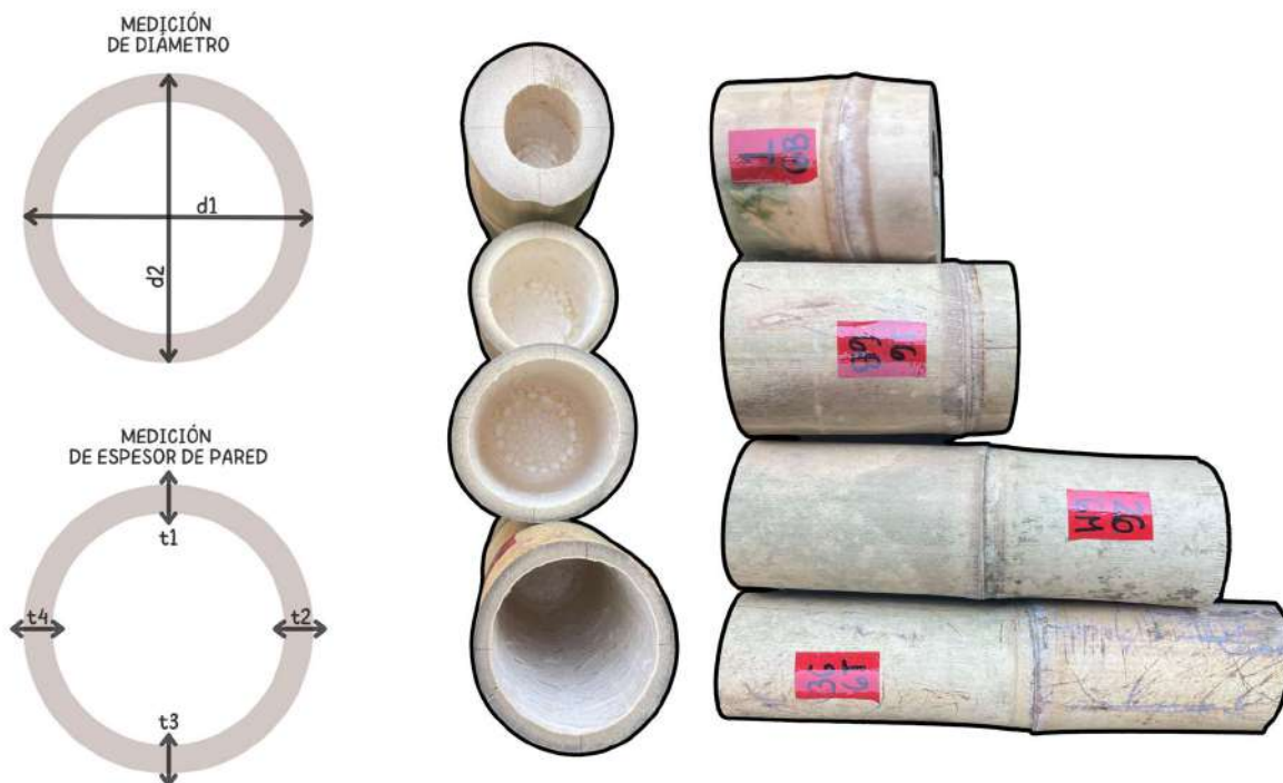
Figura 127. Medición de diámetro y espesor de pared. Variabilidad en la geometría del culmo
