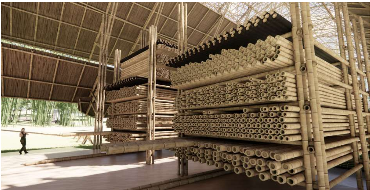
Figura 217. Almacenamiento de varas de 6 metros y 3 metros.
