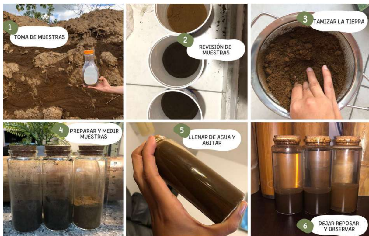
Figura 166. Procedimiento para prueba casera de granulometría.
