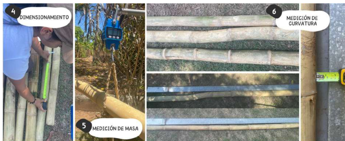
Figura 124. Caracterización física de los culmos previo a los estudios geométricos: dimensionamiento, medición de masa y curvatura.
