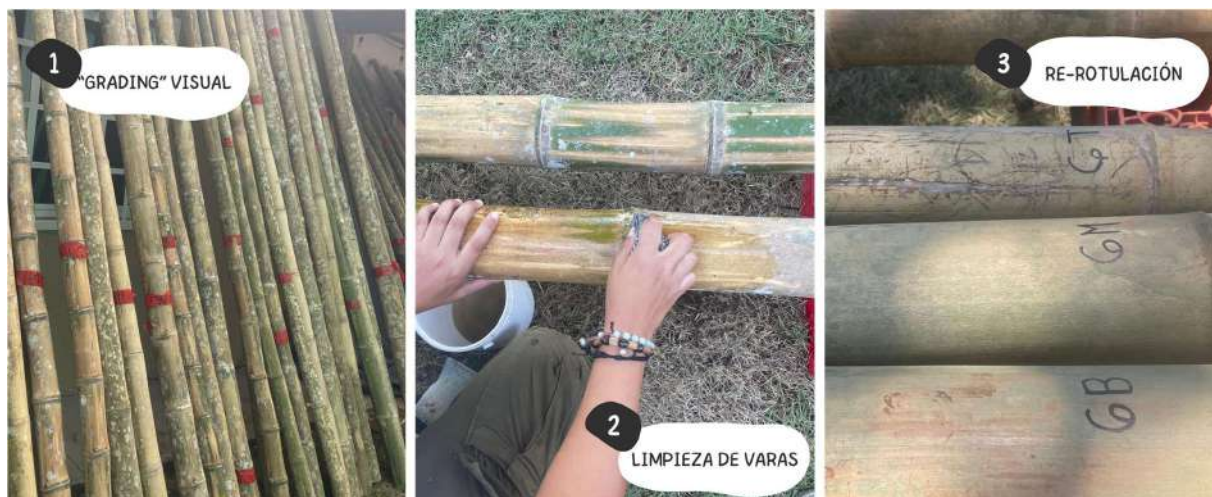
Figura 123. Preparación de especímenes para caracterización geométrica: clasificación, limpieza y rerotulación.
