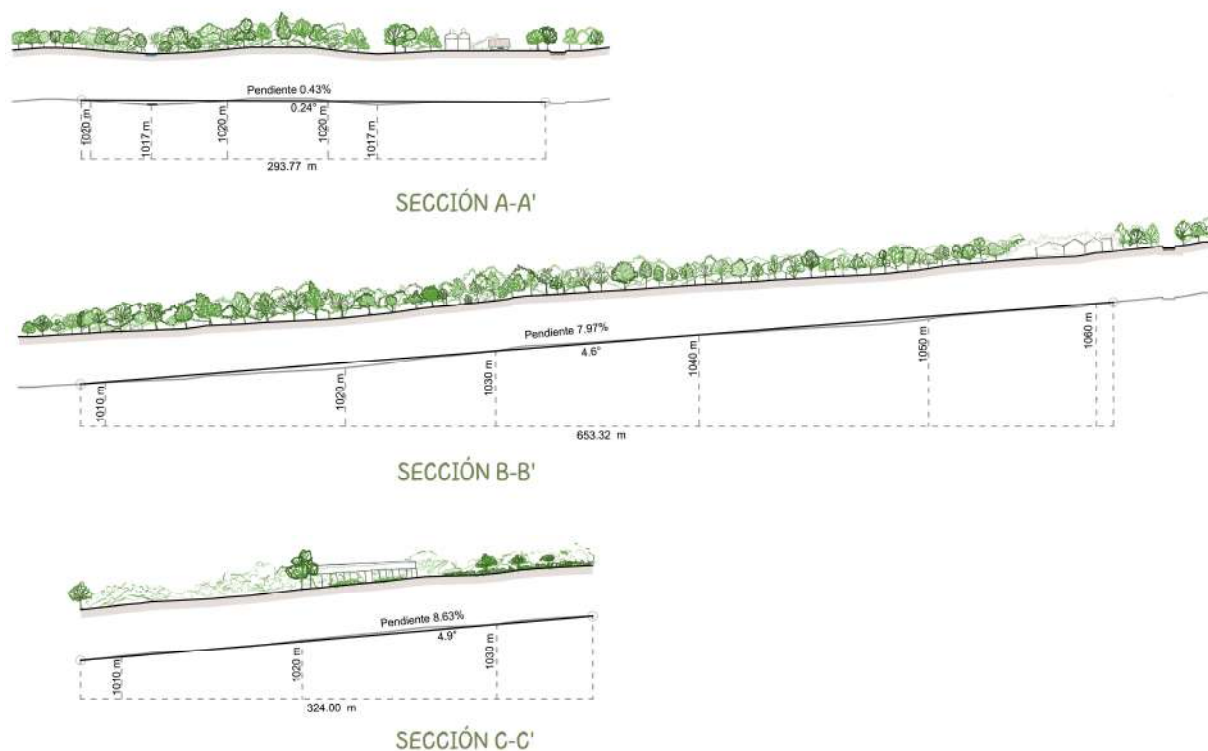
Figura 154. Secciones longitudinales y transversales.
