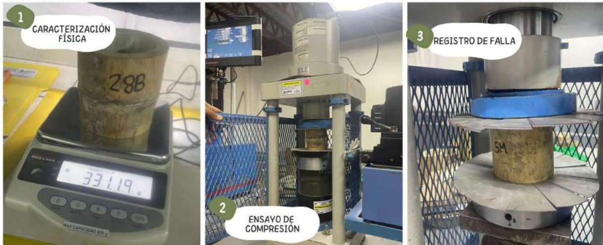
Figura 142. Procedimiento para ensayos de compresión: caracterización física, ensayo y registro de falla.
