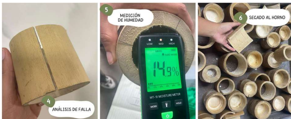
Figura 137. Procedimientos finales de prueba de corte: análisis de falla, medición de humedad y secado al horno.
