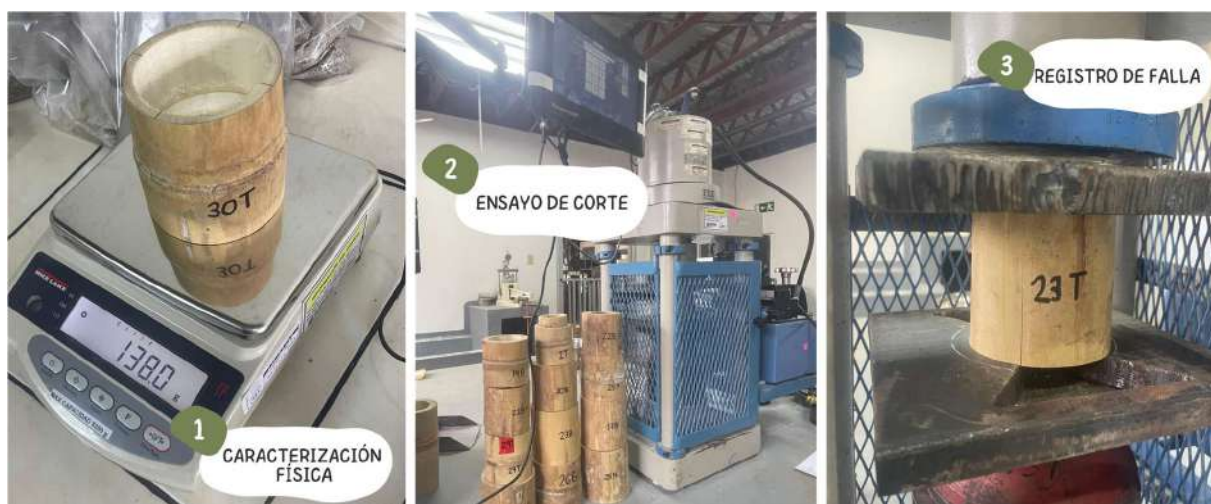
Figura 135. Procedimiento para ensayos de corte: caracterización física, ensayo y registro de falla.
