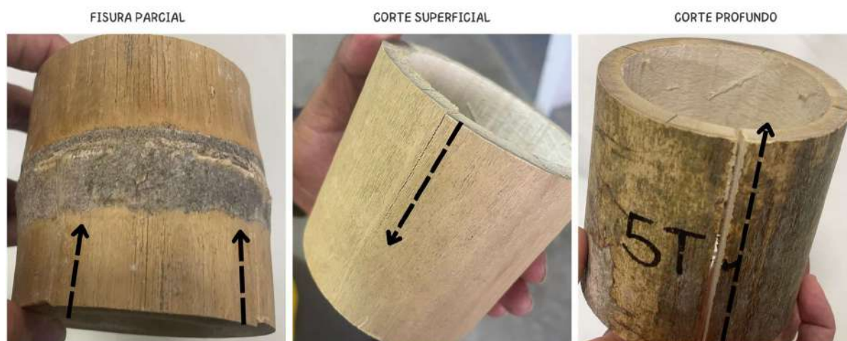
Figura 136. Análisis de las fallas observadas en la prueba de corte: fisura parcial, corte superficial y corte profundo.
