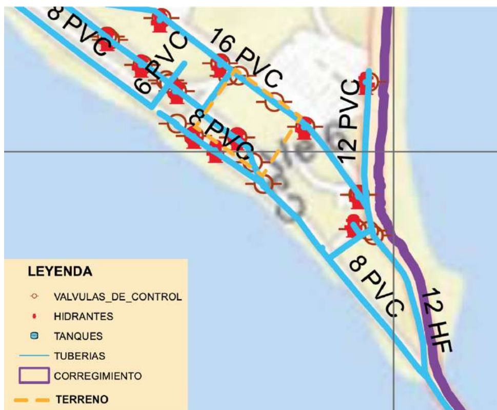
Figura 37. Trazado de tuberías de agua. Fuente: IDAAN.
