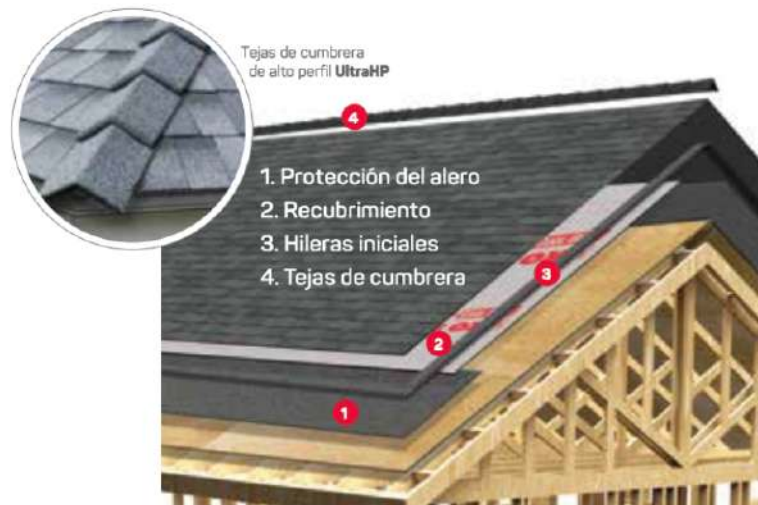
Figura 73. Instalación de tejas asfálticas. Fuente: https://www.iko.com/blog/es/how-to-install-shingles/
