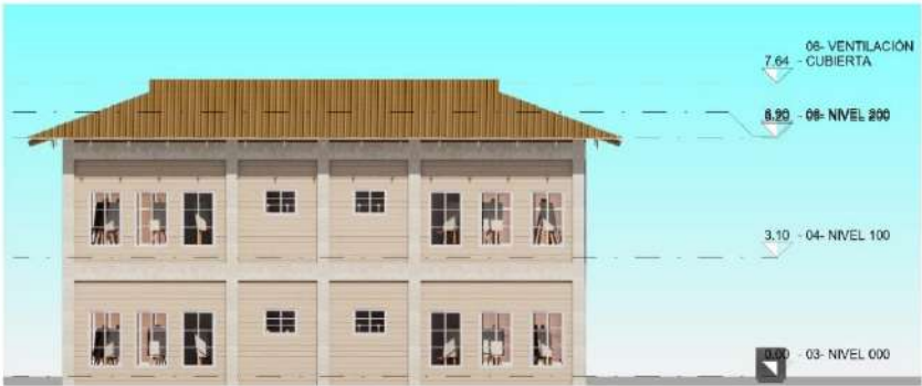
FACHADA LATERAL DERECHA ESCALA: 1:100
