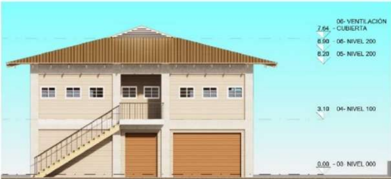
FACHADA LATERAL IZQUIERDA ESCALA: 1:100
