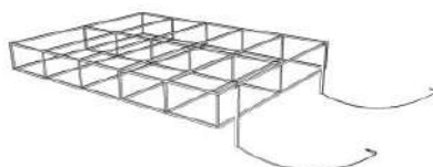
Imagen 11 Montaje de la estructura de los flotadores, fuente: IBACETA, 2012
