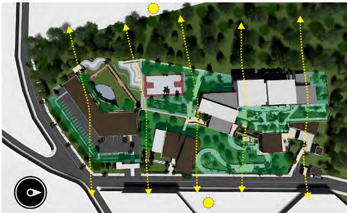
Ilustración N° 103: Esquema de amortiguación de asolación gracias a la arborización existente dentro del proyecto. / Fuente: Elaborado por Julieth R.
