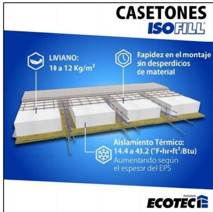
Ilustración 141-Detalle losa liviana Ecotec ISO-FILL
