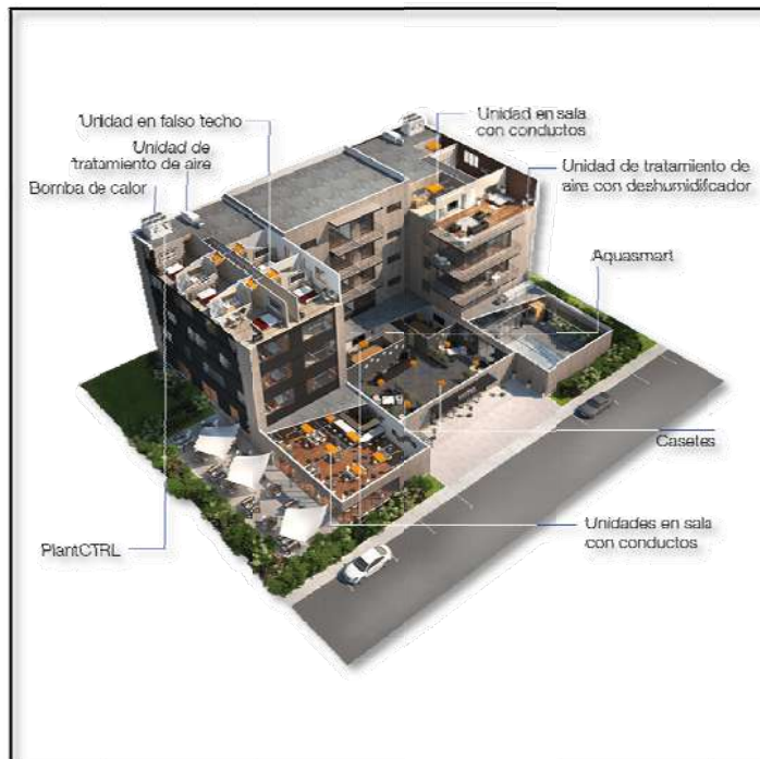
Ilustración 152-Sistemas acondicionador de aire y calefacción.
