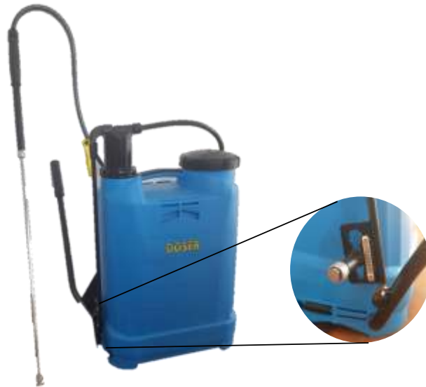
Figura 5. Bomba de mochila con dosificador para aplicar los nematicidas de la prueba
