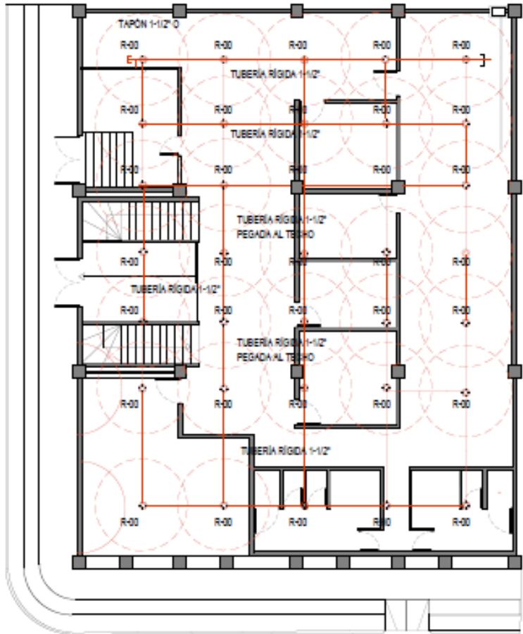
PLANTA DE SÓTANO - ROCIADORES CONTRA INCENDIO ESCALA 1:150
