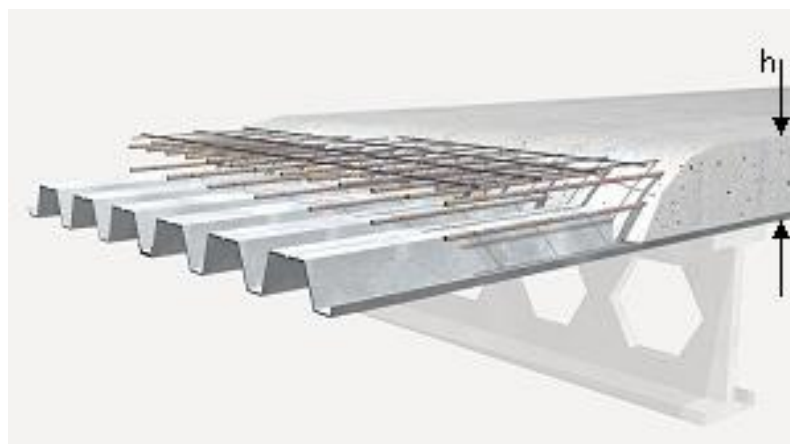
Figura Núm.42 Lámina acanalada para el vaciado de losa
