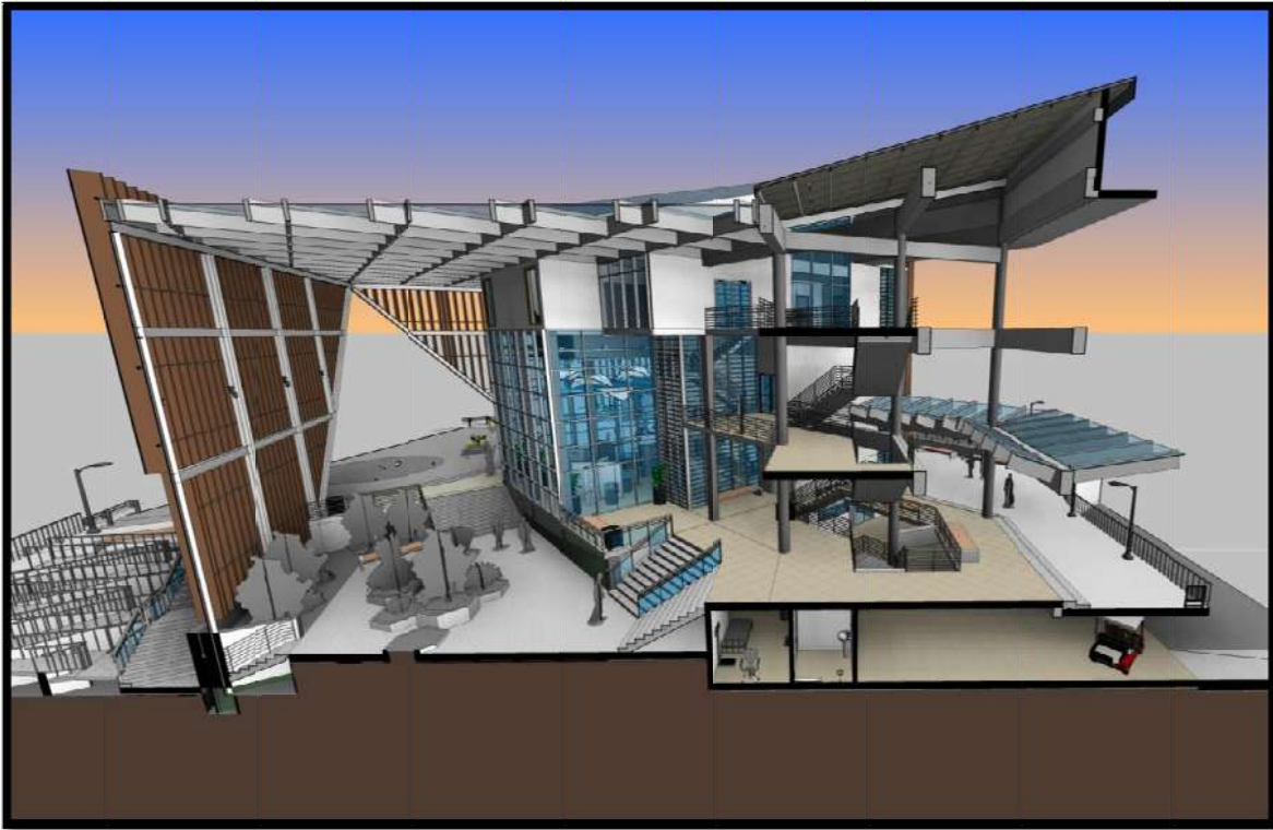
Ilustración 112-SECCION FUGADA - ATRIO CENTRAL / PATIO INTERIOR
