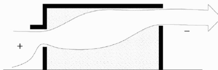
VENTILACIÓN NATURAL LOCALIZACIÓN DE SALIDA
