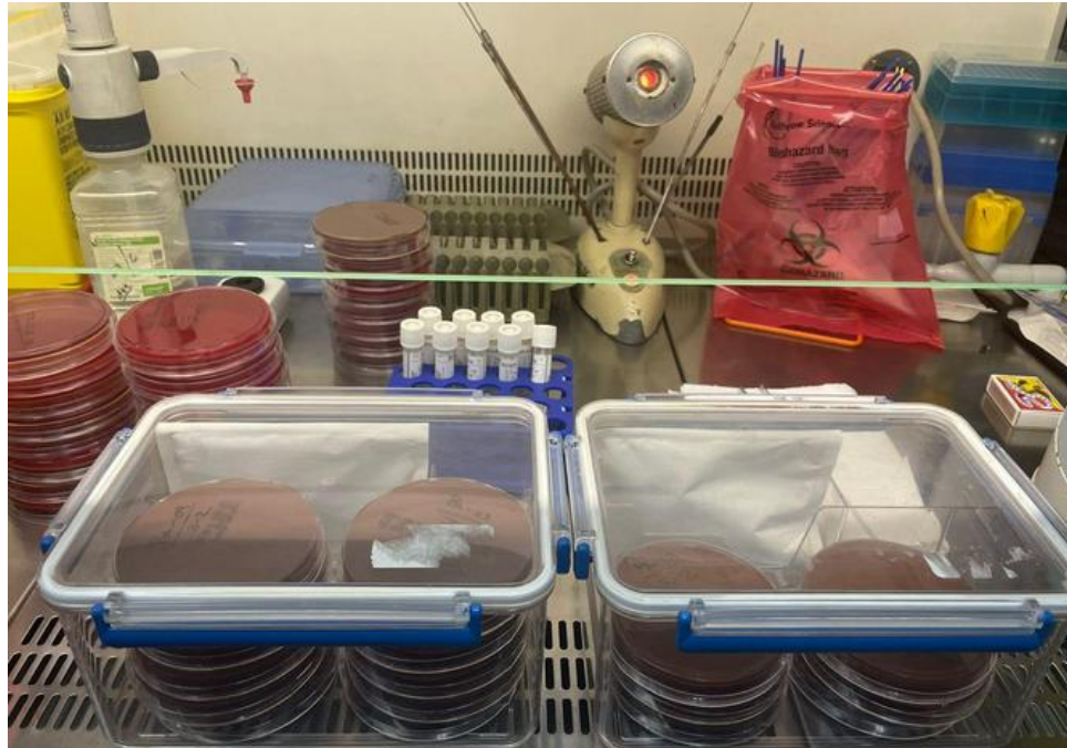
Figura 14: Sistema de incubación anaeróbica.
