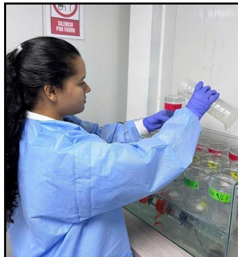
FIGURA 1. Llenado de microcosmos con agua filtrada del afluyente durante la instalación del experimento en condiciones de laboratorio.
