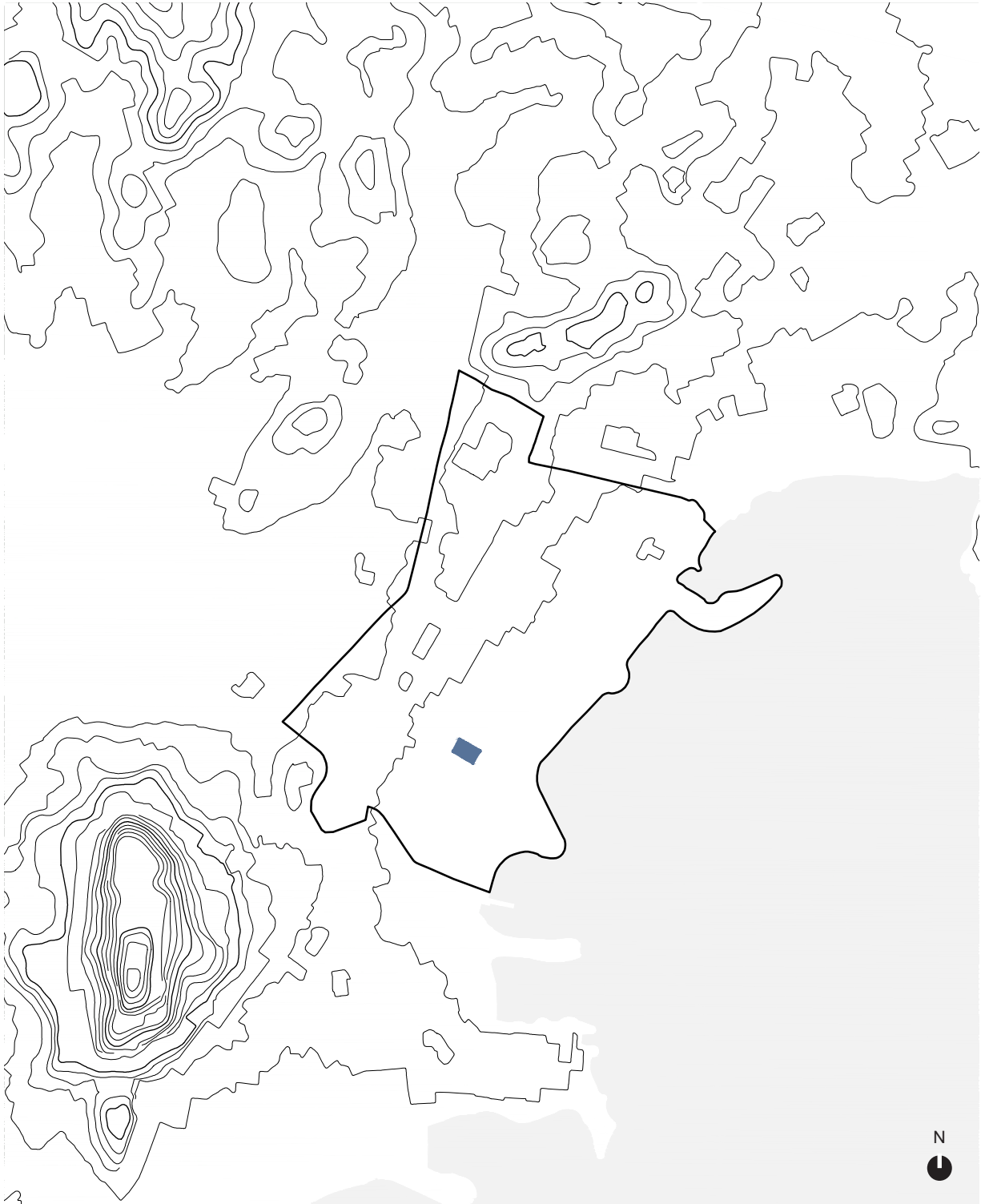
▲ IMG 27. Topografía del Corregimiento de Calidonia. Intervalo de cotas cada 10 metros. Escala 1:2500. Elaborado por el autor. Datos obtenidos de: https://sigintg.anati.gob.pa/mallas_pdf/4242_I_NE.pdf
