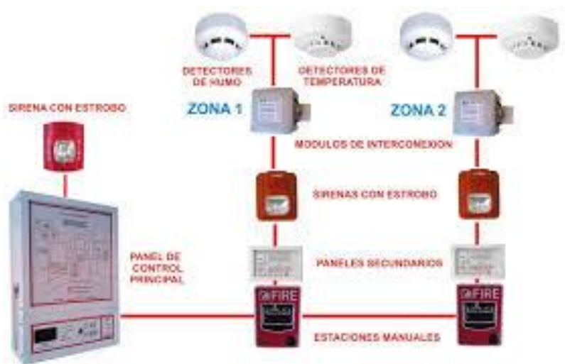
Ilustración 49: Sistema de alarma contra incendios.
