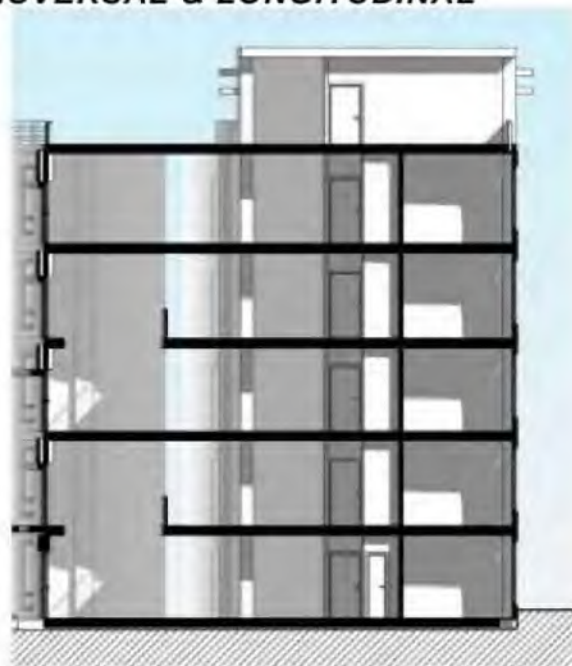
1 Seccion Transversal del Edificio de Habitaciones Esc: 1/200
