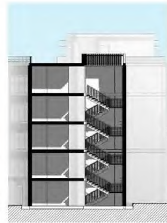
4 Seccion de Escaleras Laterales Esc: 1/200
