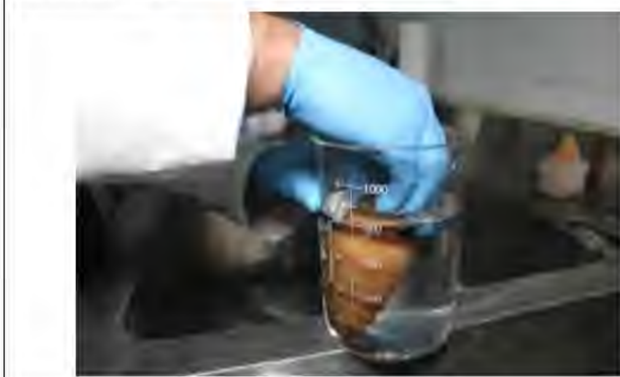
Figura 11. Inmersión de una pieza en agua desionizada
