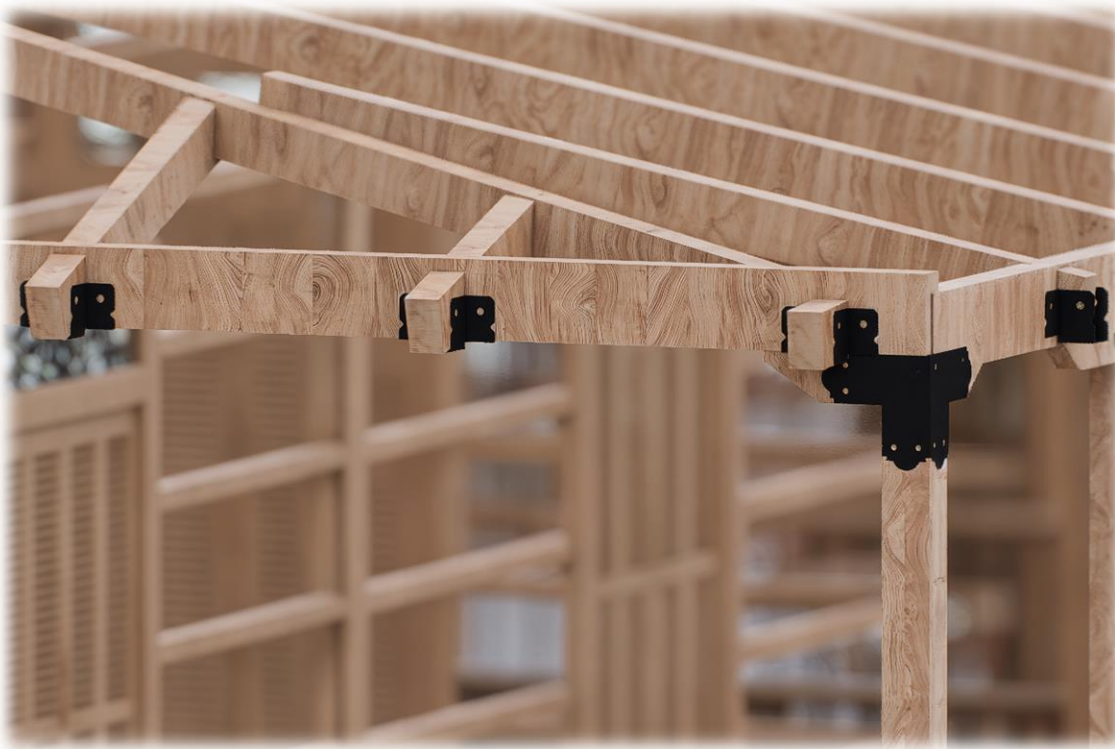
Ilustración 31: detalle de uniones metálicas contemporáneas. (Elaboración propia, 2023)
