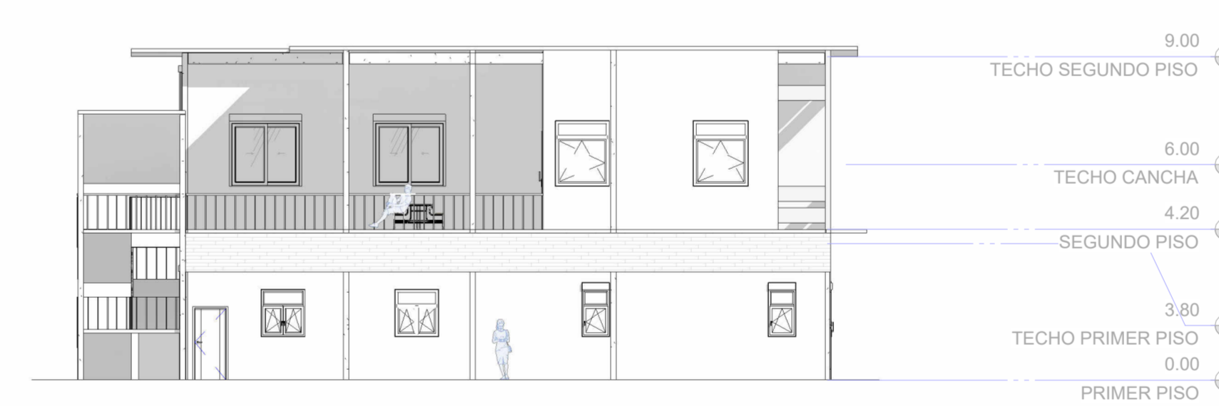
6 ELEVACIÓN EDIFICIO 2 - O ESCALA 1 : 150
