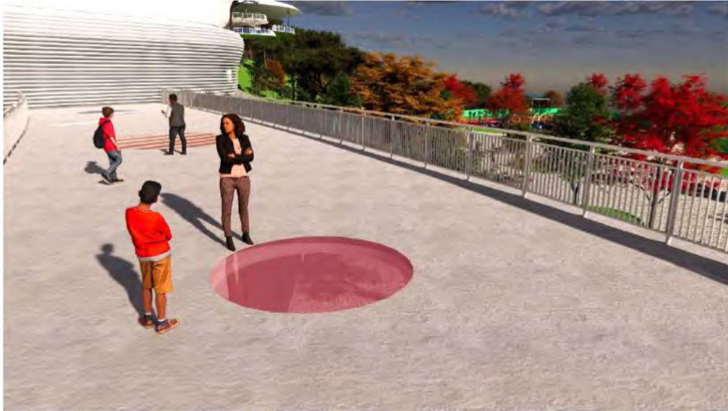
Render 25 Vidrio pisable incorporado en el puente. Fuente: Elaborado por: Ys.
