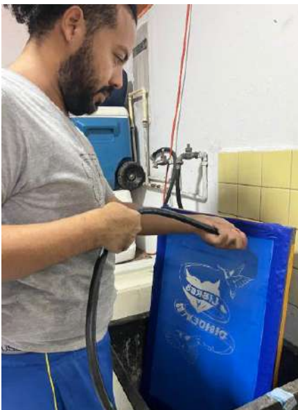
Figura 87 Revelado de malla para serigrafía
