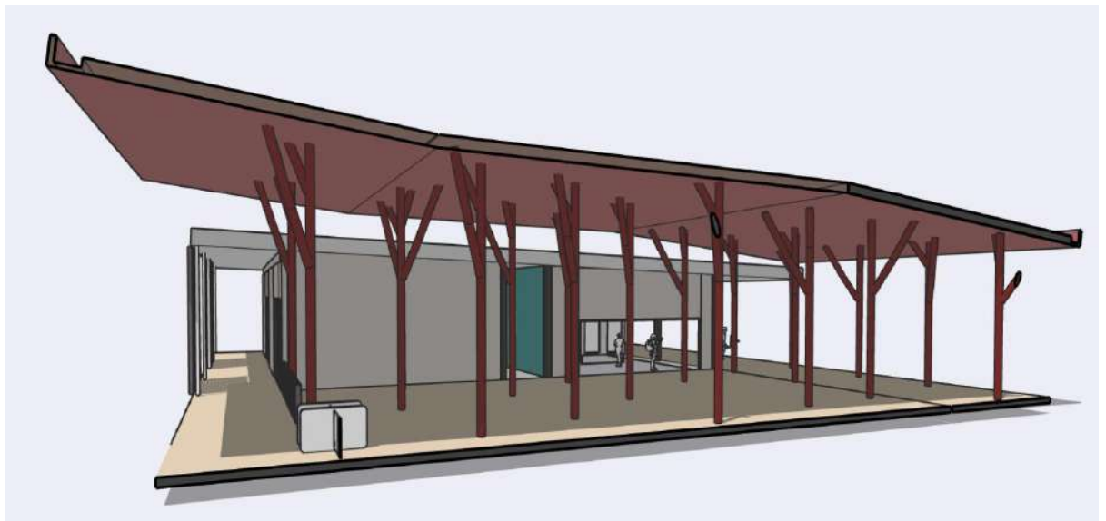
Ilustración 60, isométrico y corte del edificio de visitantes donde en el patio central observamos las columnas que buscan simular los troncos y ramas de árboles dando la sensación de estar en un bosque dentro del edificio. Elaborado por el autor.
