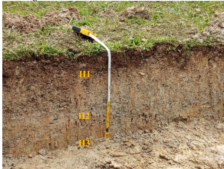
Figura 35. Corte calicata. Profundidad 0.50m
