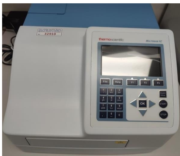
Figura 16. Espectrofotómetro de microplacas Thermo Scientific Multiskan
