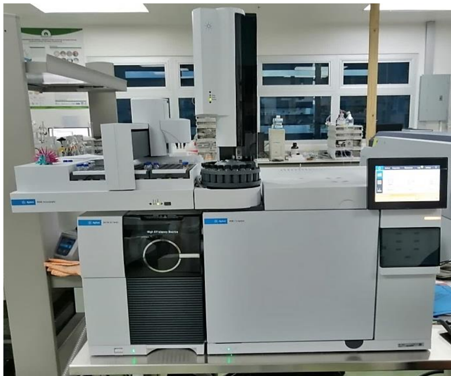
Figura 17. Cromatógrafo de gases Agilent 5977 GC/MSD con muestreador automático
