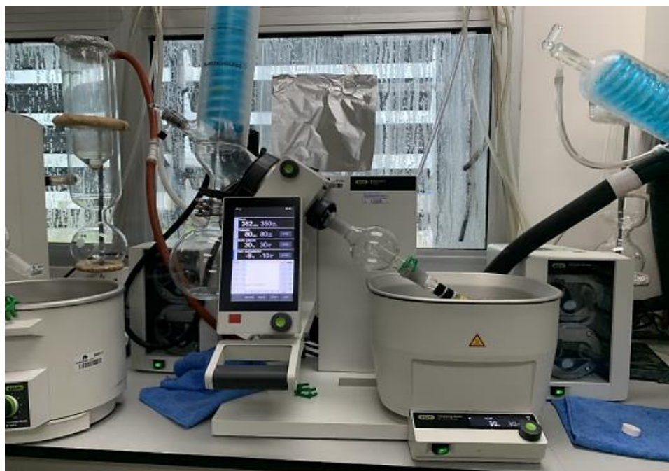
Figura 15. Evaporador rotatorio Buchi R300
