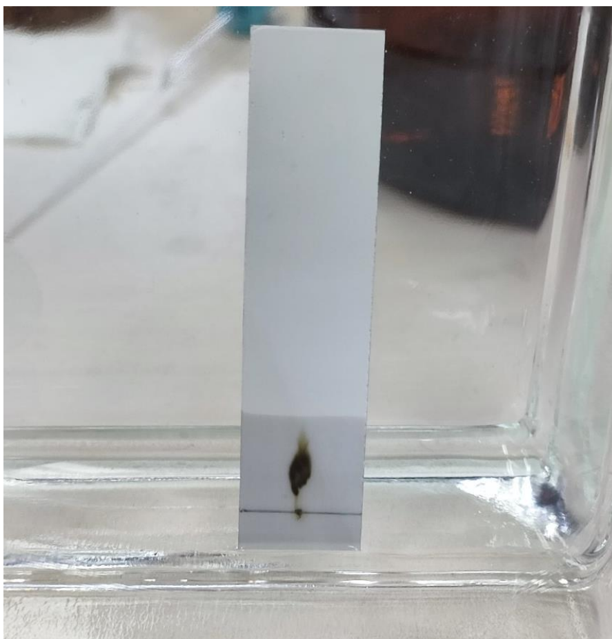
Figura 40. TLC (fase normal) de la fracción de metanol
