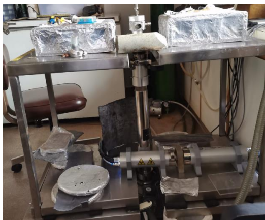
Figura 3.3. Espectroscopio Mössbauer de Iron analytics. Laboratorio de espectroscopia Mössbauer Universidad de Panamá.
