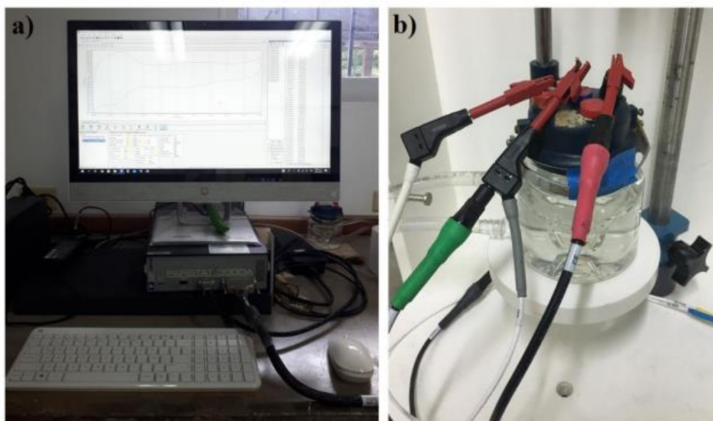
Figura 3.4. a) Potenciostato-galvanostato PARSTAT 3000A y software VersaStudio b) Celda electroquímica de tres electrodos con electrodo de referencia Ag/AgCl saturado, contraelectrodo de platino y electrodo de pasta de carbón.
