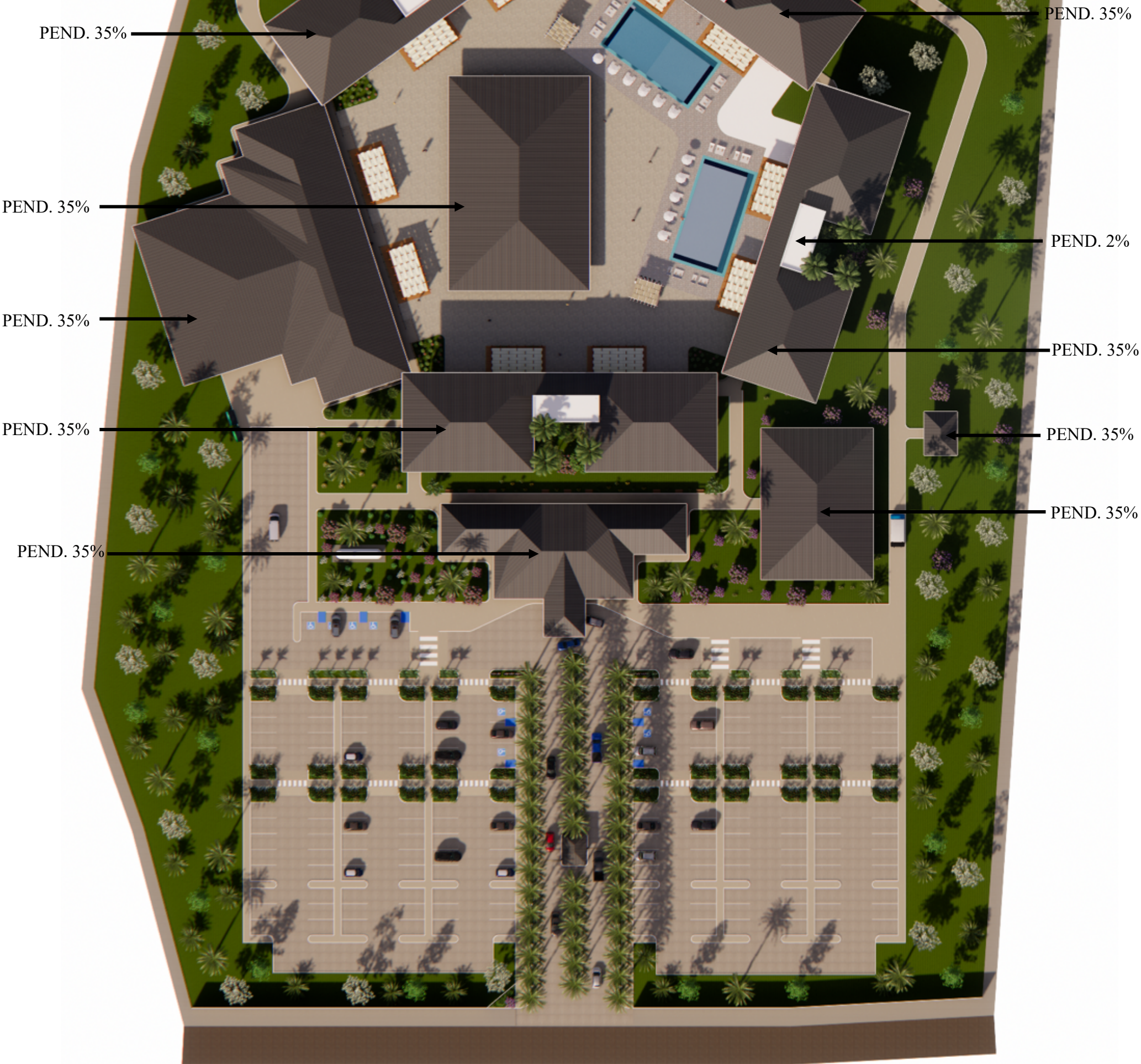
PLANTA GENERAL DE CUBIERTAS S/E
