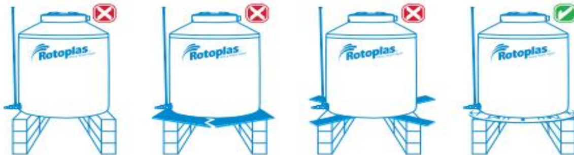
Fig.5. Forma correcta de colocar el tanque de almacenamiento para agua.
