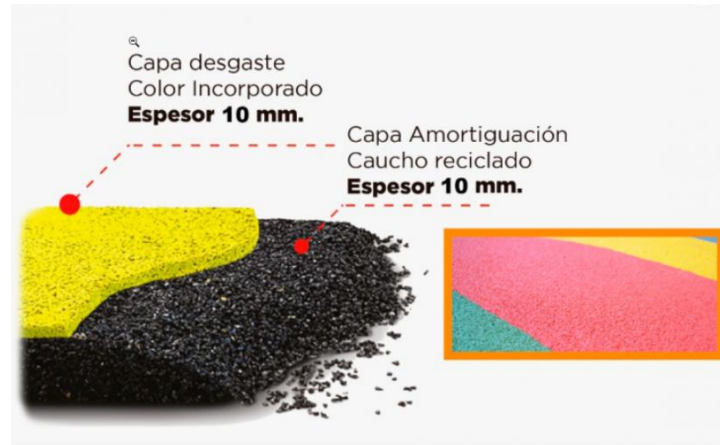
Ilustración 51. Detalle técnico del sistema amortiguante MARCO-PC1. Fuente: (Marcopark., 2021).
