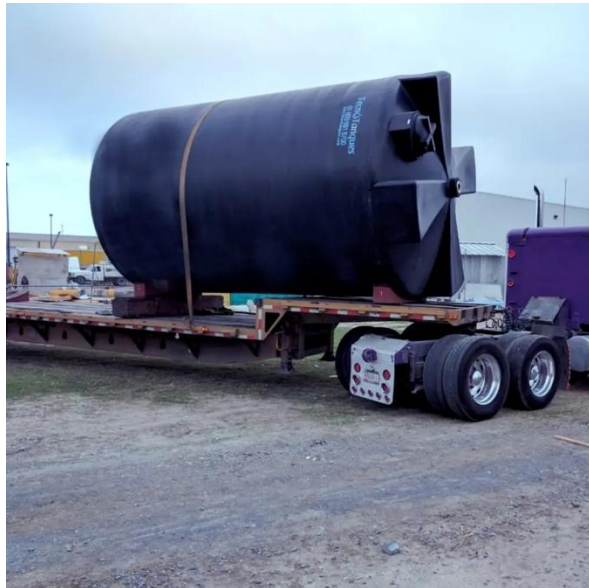
Imagen 83- Referencia de tanque de agua de 8,000 galones para sistema contra incendio.
