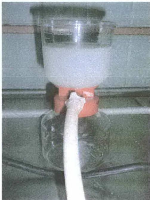
FILTRANDO EL AMORTIGUADOR DE BLOQUEO.
