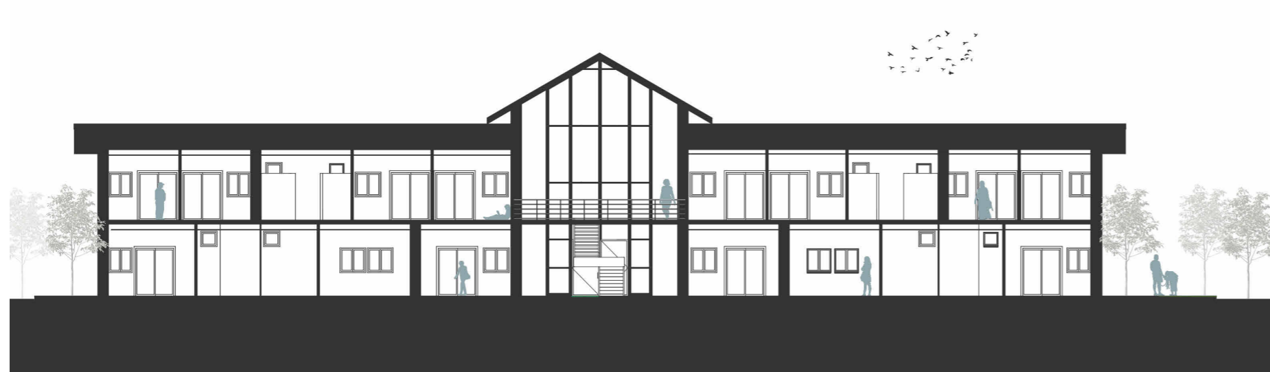
EDIFICIO SEMI PRIVADO - SECCIÓN A-A
