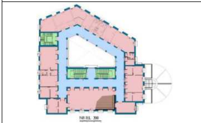
Figura 56: Esquemático de nivel 200, para observar la forma poligonal de la planta, con el eje de simetría y el anexo formado por el anfiteatro. Fuente autor. Dibujo sobre base de archivo de (Sosa Arquitectos Urbanistas Consultores, 2007)
