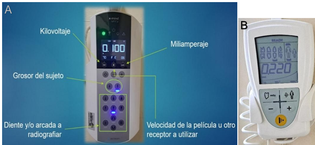
Figura 1.3 A. En el panel, también se puede ajustar el kVp y el mA. B. El panel contiene también, el cronorruptor (botón naranja).
