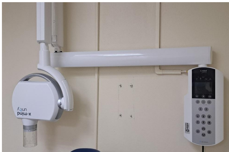
Figura 1.4 Posición correcta del equipo de rayos X dental mientras no se esté utilizando.
