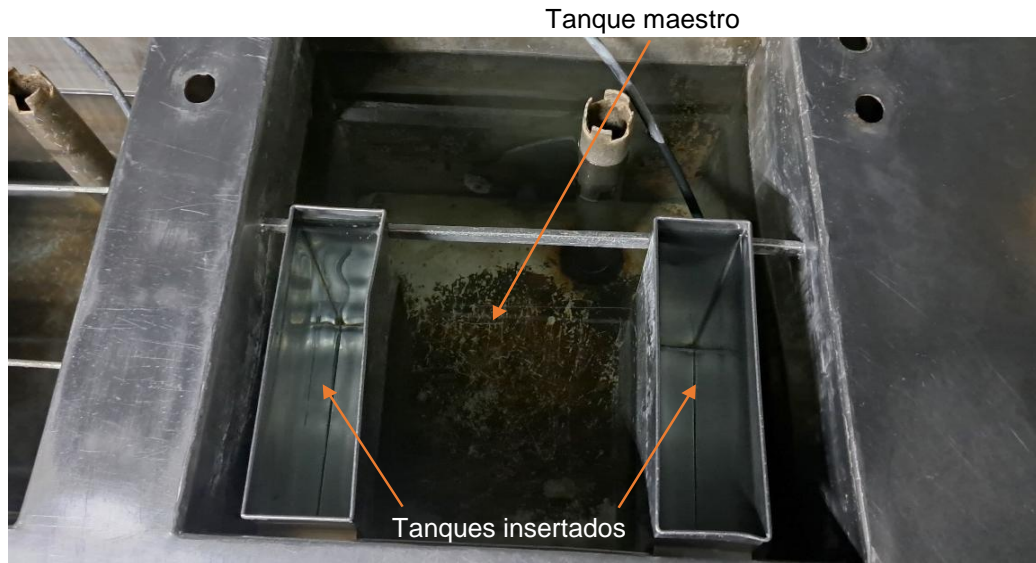
Figura 4.9 Tanques de fijador insertados dentro del tanque maestro.
