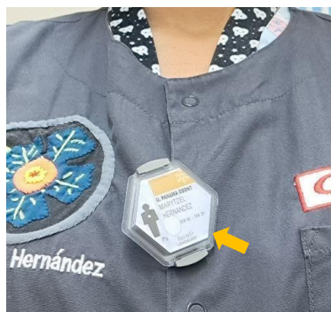
Figura 2.11 Dosímetro utilizado por el personal, Sección de Radiología, Facultad de Odontología, Universidad de Panamá
