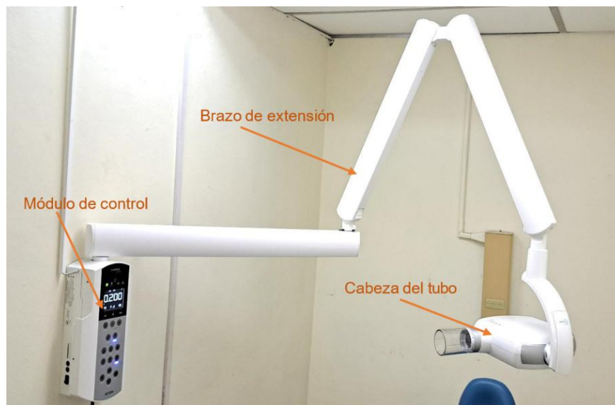
Figura 1.1 Partes principales (básicas) del equipo de rayos X dental, Facultad de Odontología de la Universidad de Panamá.
