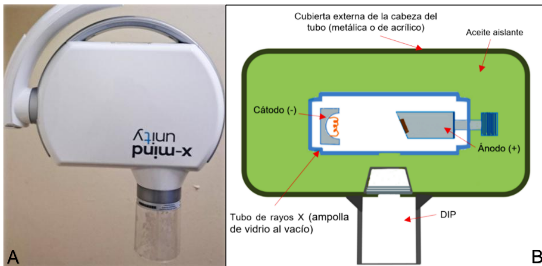
Figura 1.5 A. Cabeza del tubo de rayos X vista externamente. B. Esquema de la cabeza del tubo vista internamente. Fuente: B. Adaptado de (4).
