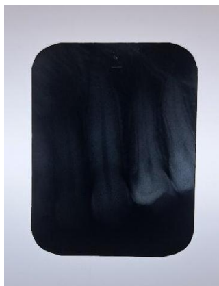
Figura 7.3 Película sobreexpuesta a los rayos X.
