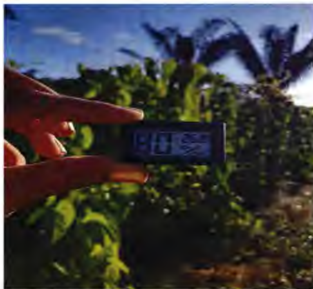
Figura 15. Mini-higrómetro electrónico digital de la marca Pgzsy para medir humedad y temperatura. Fuente: Sánchez, 2024.
