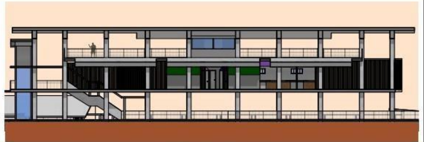
SECCION LONGITUDINAL "A-A" EDIFICACION "D" ESC 1:250
