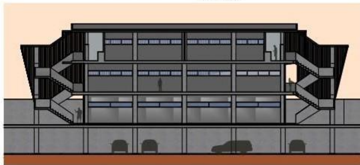
SECCION LONGITUDINAL "A-A" EDIFICACION "B" ESC 1:250
