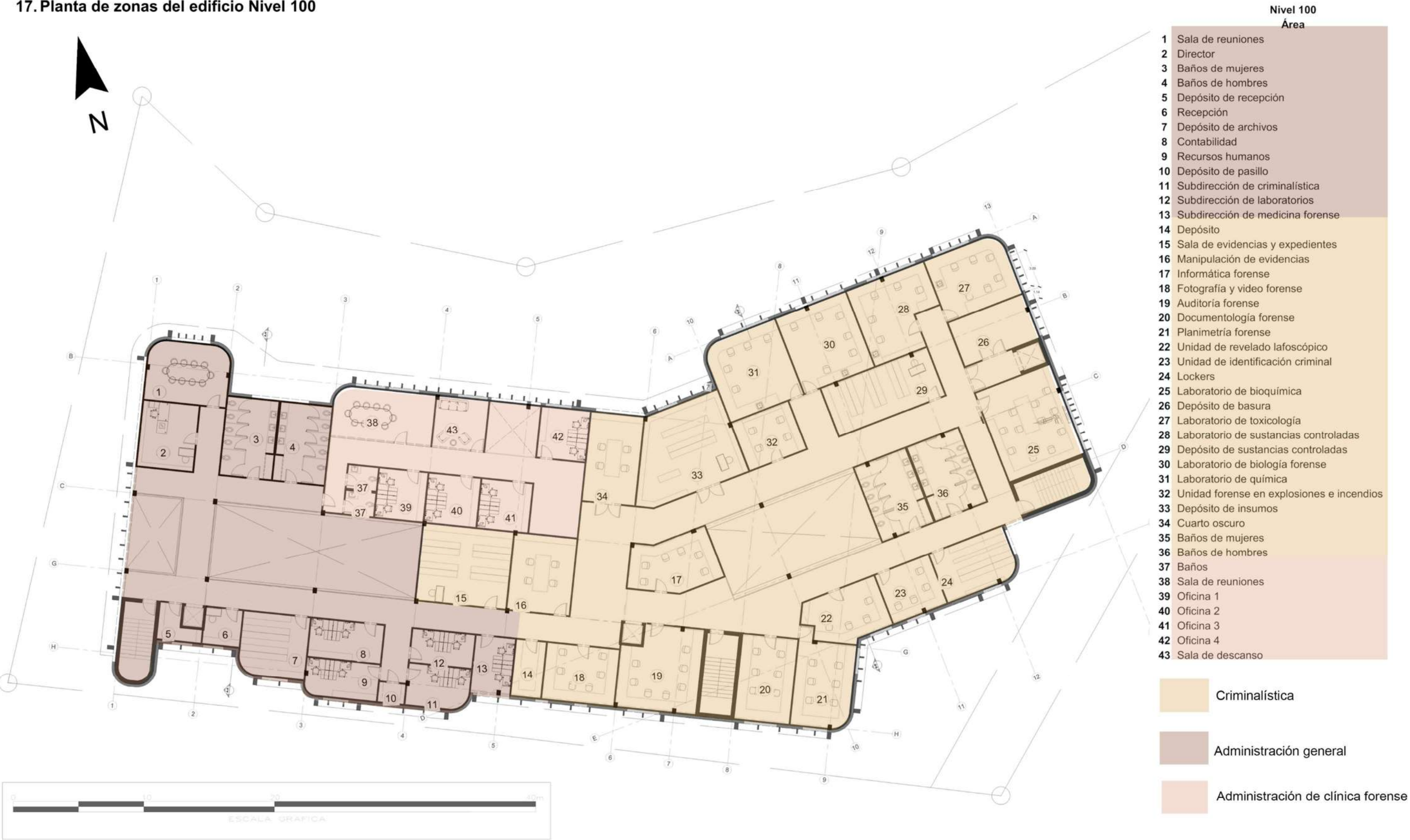
17. Planta de zonas del edificio Nivel 100
