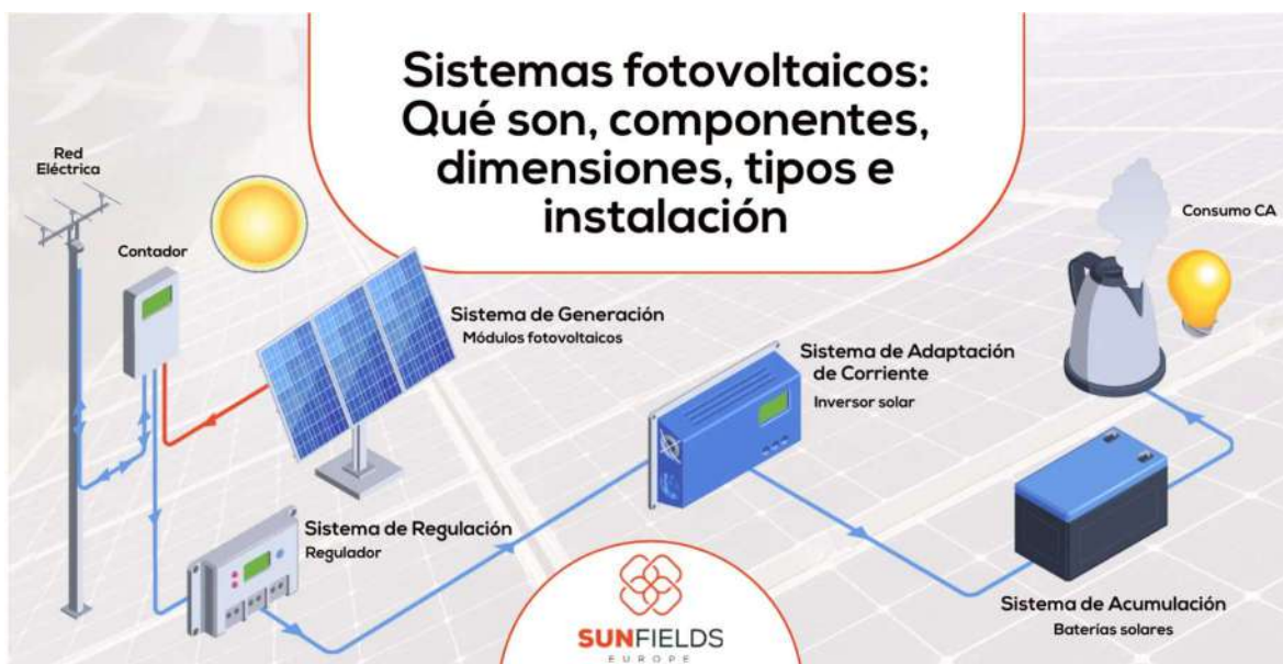
Ilustración 58: Componentes de sistema fotovoltaico. Fuente: Sunfields Europe
