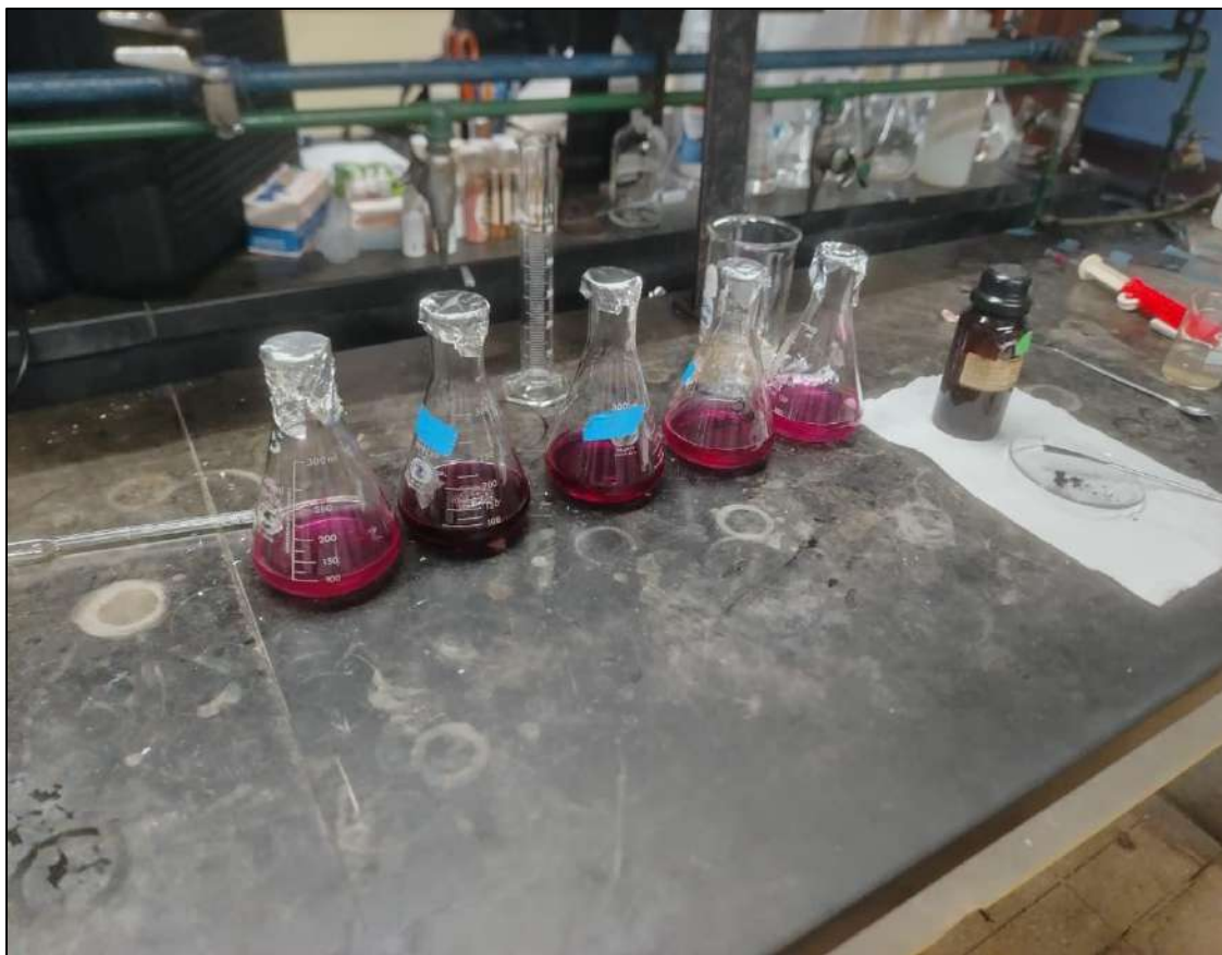
fig. 2. Titulación con EDTA de la muestra, para saber su dureza se puede observar la fase final del experimento y el cambio de color.
