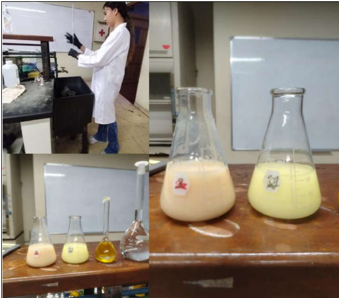
fig. 5. Se realizó un análisis de cloruros por titulación, se prepararon indicadores de K_2CrO_4 (cromato de potasio) y AgNO_3 (nitrato de plata) agua ultrapura y 5mL de la muestra de agua filtrada, se realizó hasta que hubiera un cambio de color a naranja melón. La muestra tuvo un consumo alto de titulante antes de llegar al color indicado lo que indica que el agua tenía alto contenido de cloruro.
