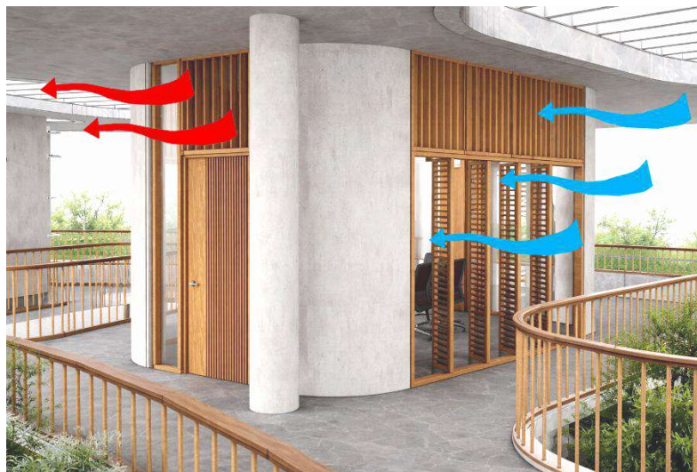
Ilustración 51. Ventilación cruzada en Centro de interpretación
