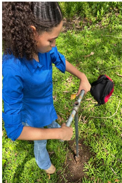
Figuras No.14, 15 y 16: Recolección de muestras de suelo en campo
