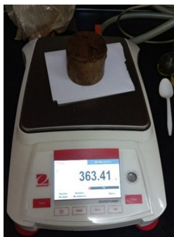
Figuras 20 y 21: Pesaje de muestras húmedas y secas
