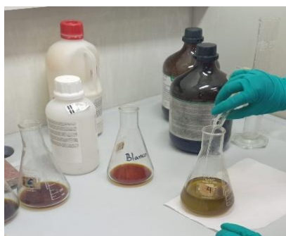
Figuras 39 y 40: Adición de los 20 ml H_2SO_4 y 200 ml a agua destilada
