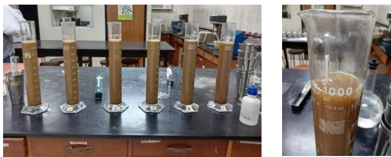
Figuras 23 y 24: Cilindros sedimentarios; Método de Bouyoucos
