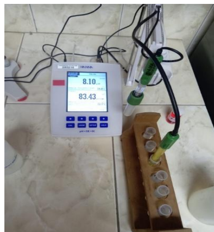
Figura 35 y 36: Filtrado de muestras y lectura de muestras por conductímetro
