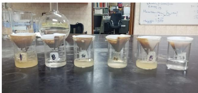
Figura 35 y 36: Filtrado de muestras y lectura de muestras por conductímetro
