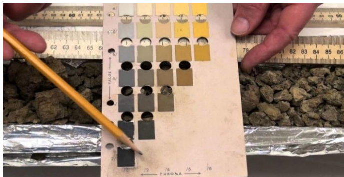
Figura 8: Determinación de color con el Sistema de Munsell. Fuente: Portal frutícola, 2019.
