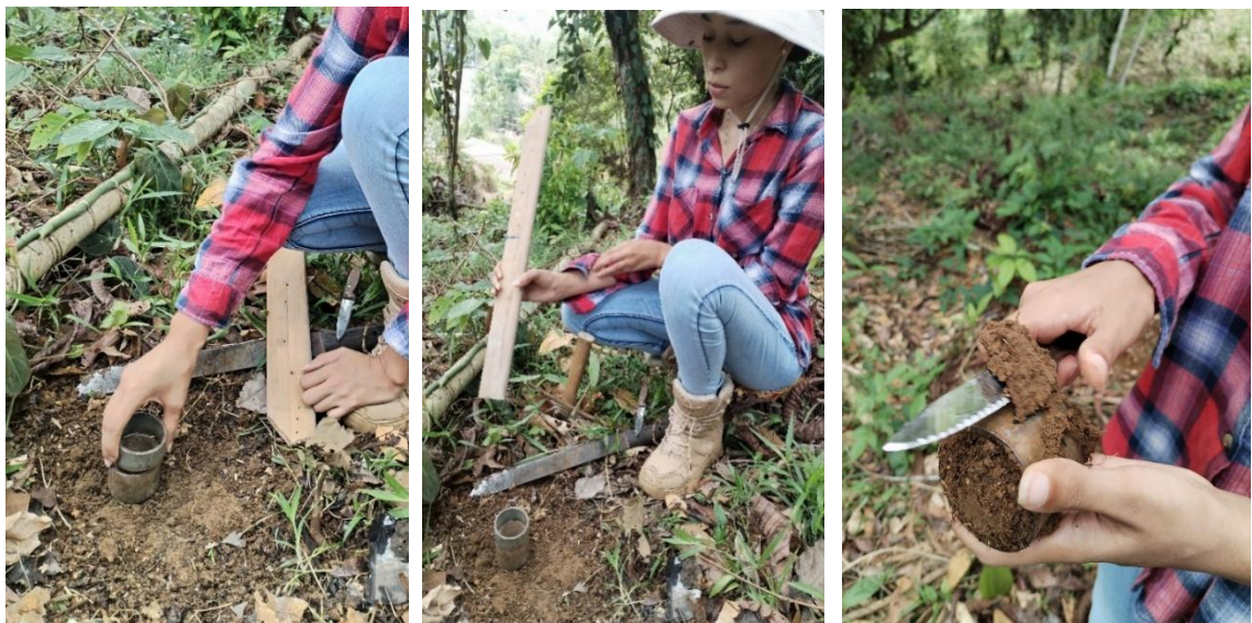
Figuras No.17, 18 y 19: Método de cilindro metálico para densidad aparente
