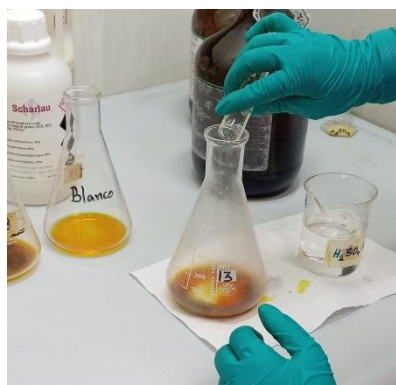
Figuras 39 y 40: Adición de los 20 ml H_2SO_4 y 200 ml a agua destilada
