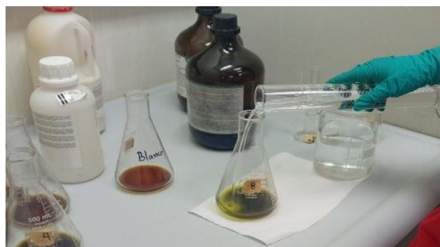
Figuras 39 y 40: Adición de los 20 ml H_2SO_4 y 200 ml a agua destilada
