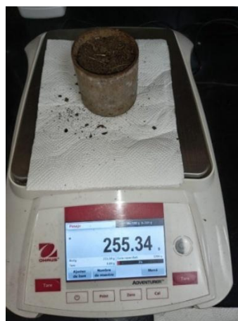
Figuras 20 y 21: Pesaje de muestras húmedas y secas
