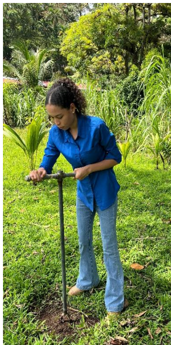
Figuras No.14, 15 y 16: Recolección de muestras de suelo en campo
