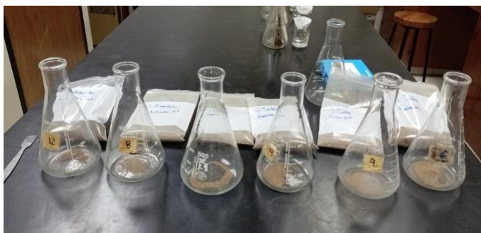
Figuras 37 y 38: Preparación de muestras y adición de los 10 ml de dicromato de potasio ( K_2Cr_2O_7 1.0N)
