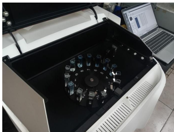
Figuras 31 y 32: Desarrollo de color y lectura de muestras en el colorímetro
