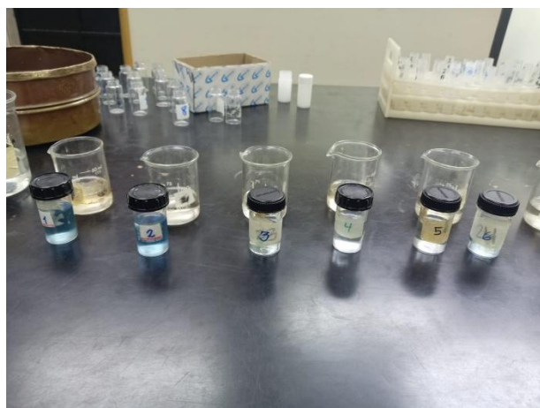
Figuras 31 y 32: Desarrollo de color y lectura de muestras en el colorímetro
