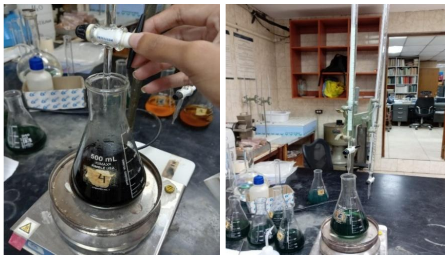
Figuras 43 y 44: Titulación de muestras con sulfato ferroso
