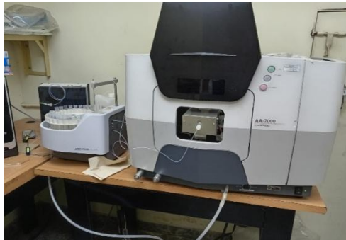
Figuras 33 y 34: Empleo de equipo de absorción atómica
