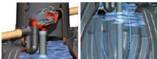
Imagen 53: Rebosado y Captación de agua. Producido en achicad por el autor 39
