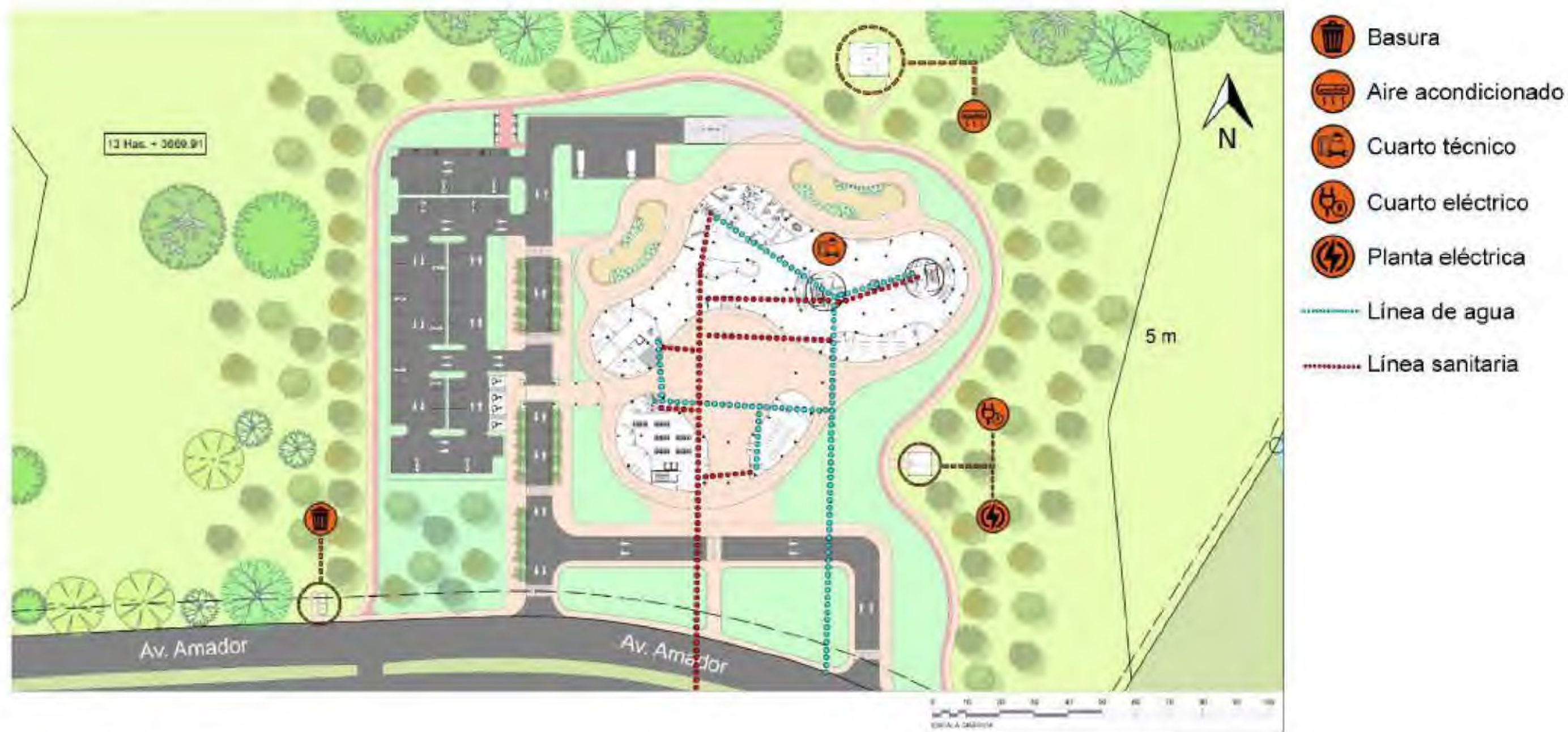
Plano 03 (Planta de instalaciones)
