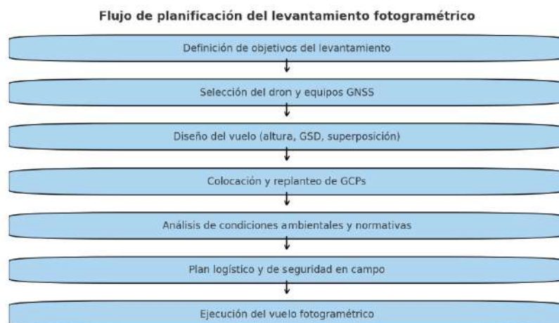
Fig. No.1. Diagrama de flujo planificación del levantamiento fotogramétrico
