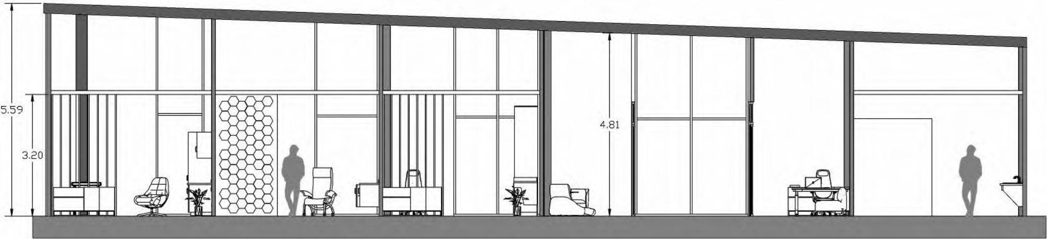
SECCIÓN LONGITUDINAL- ZONA DE REHABILITACIÓN ESC. 1:100
