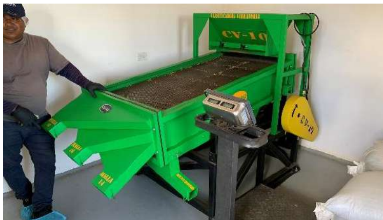
Figura 20. Máquina industrial de clasificación de granos de café
