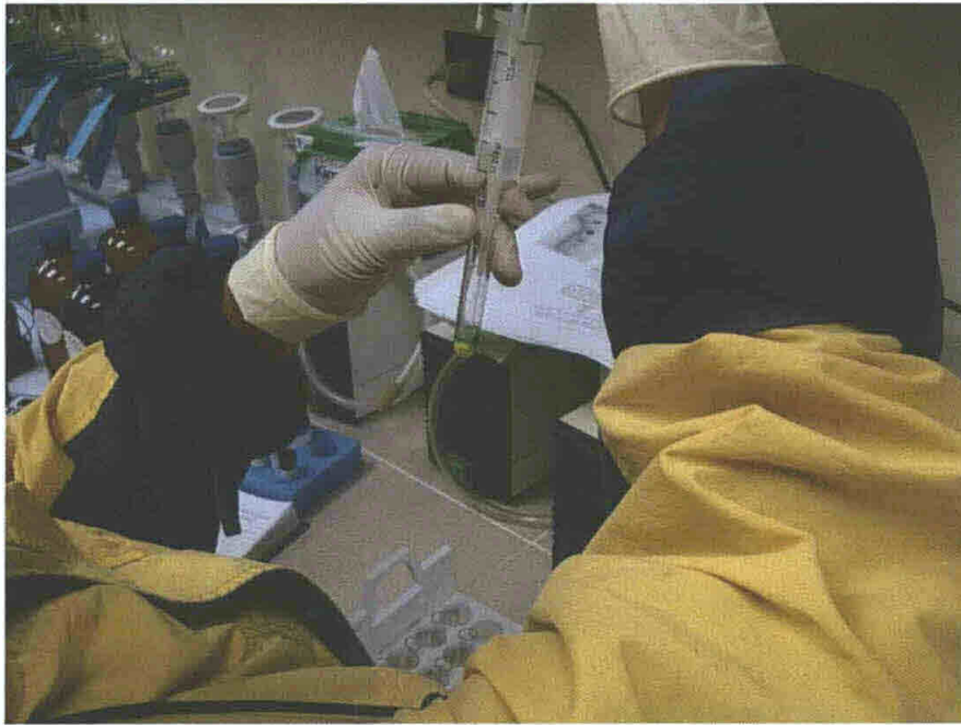
Figura 53. Análisis de microcistinas en muestras de agua
