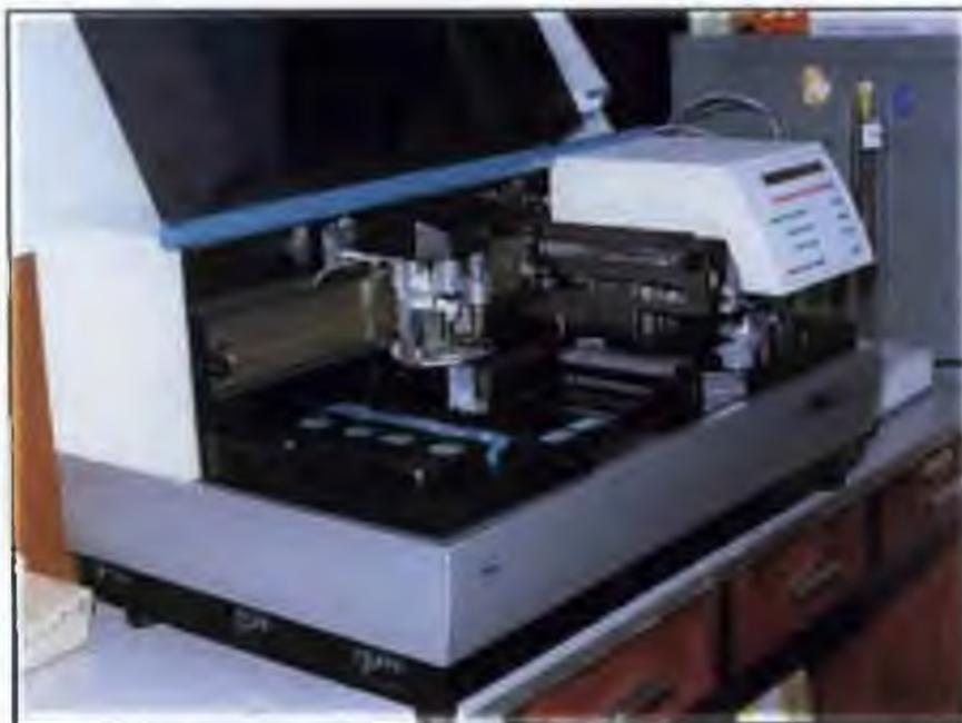
**Figura 16. Cobas Amplicor HIV-1 Monitor Test (Roche Diagnostics System) utilizado en la cuantificación del RNA del VIH-1 (carga viral)**
